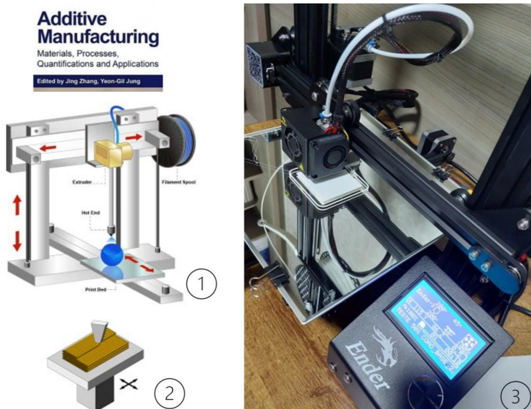
Figura 8. Processo de manufatura aditiva pela fusão de filamento termoplástico.
