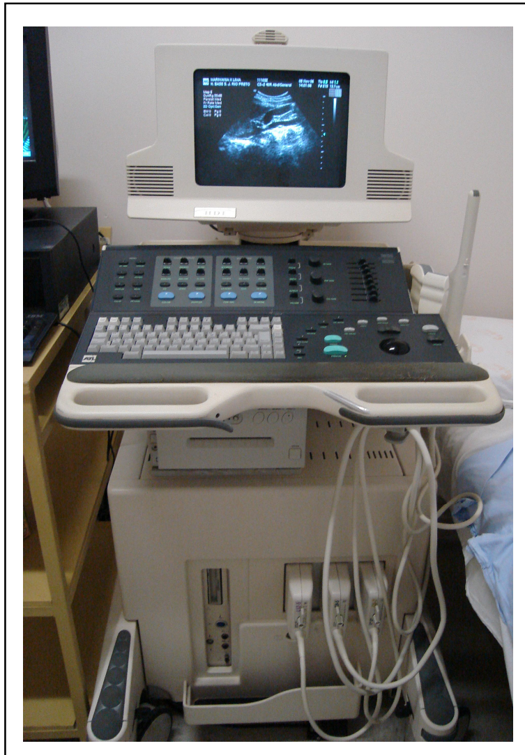
Figura 2. Aparelho de ultra-som ATL-HDI 3000 utilizado na avaliação de alterações cerebrais em crianças prematuras de muito baixo peso.
