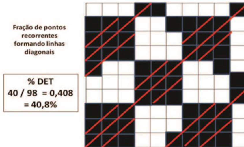
**Figura 6:** Representa o cálculo do determinismo no modelo de construção de um Gráfico de Recorrência com dimensão 1 e raio  $1^{12}$ .
