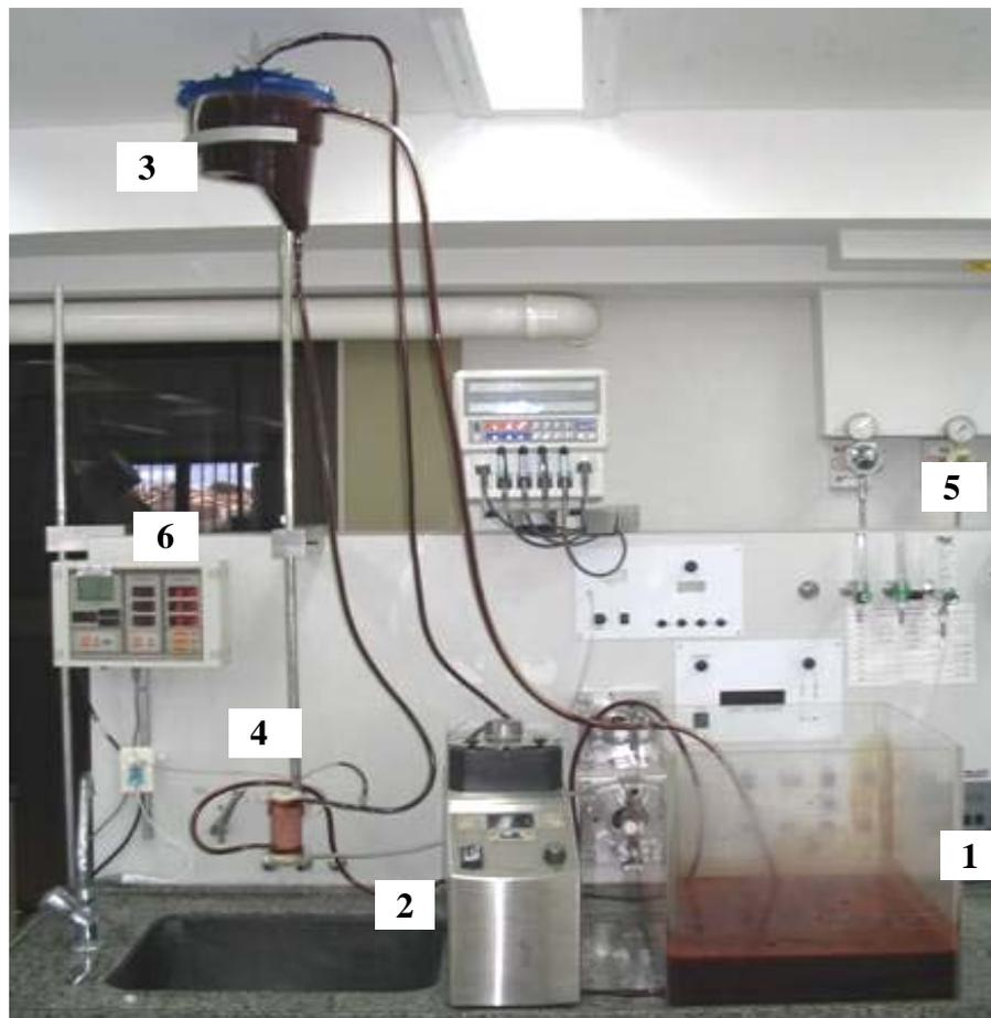
Figura 4: Bancada de Testes e Ensaio com o circuito de testes do protótipo do oxigenador de membrana de baixa resistência. 1: reservatório de manutenção de nível; 2: bomba peristáltica BEC-2000; 3: reservatório de 1,5 L de sangue; 4: oxigenador; 5: rotâmetro; 6: unidade de medição de pressão.
