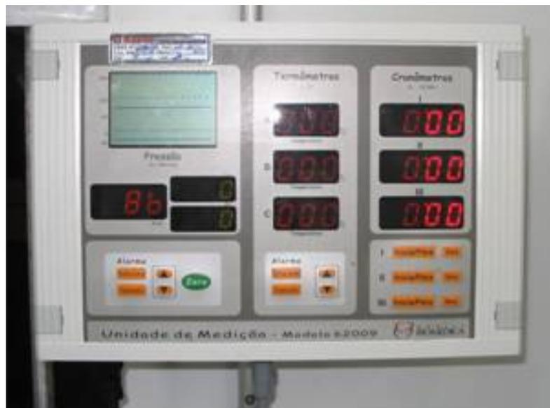
Figura 7: Aparelho condicionador de sinal de pressão.
