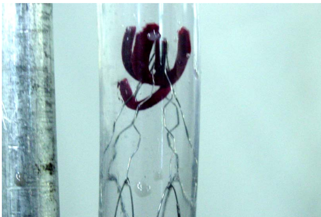
Figura 3. Fotografia mostrando a montagem do stent -filtro no sistema em tubo de PVC transparente de 2,2 cm de diâmetro interno com a captura de vários embolos pelo filtro.
