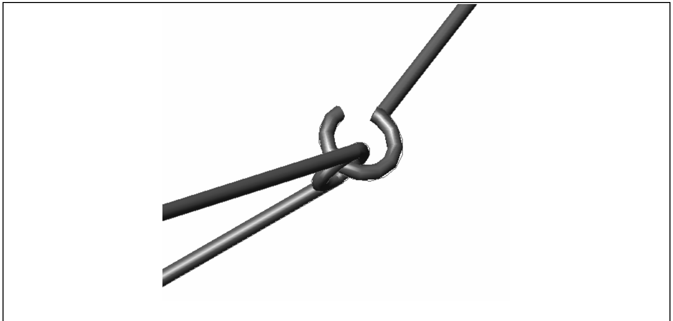
Figura 9. Esquema ilustrando em detalhe o mecanismo de união entre o stent - filtro.
