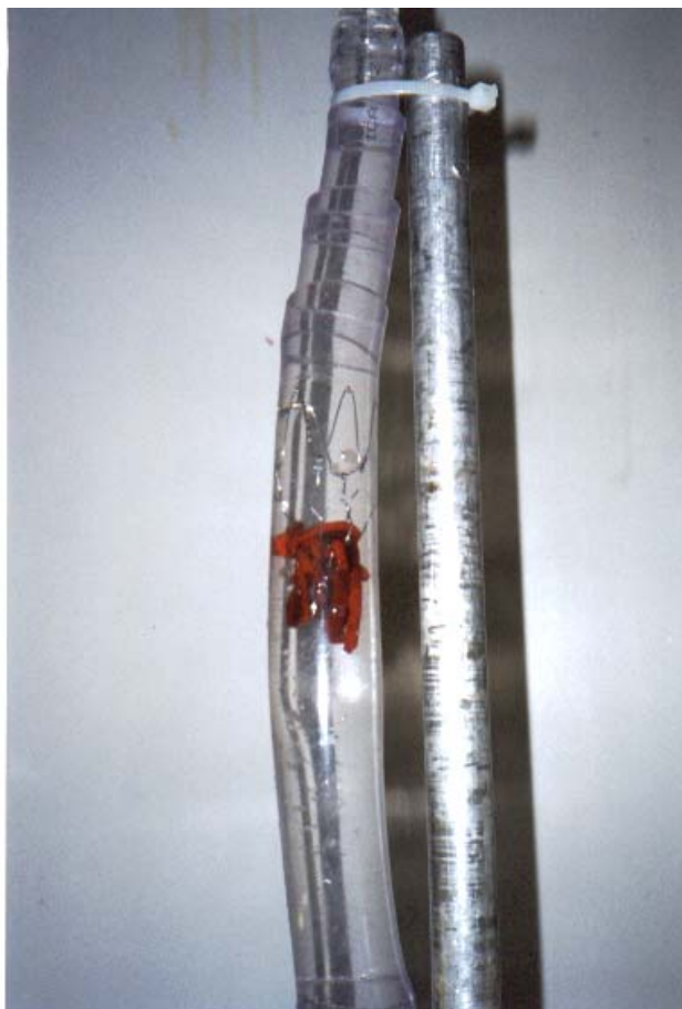
Figura 11. Fotografia mostrando a captura de vários êmbolos pelo stent -filtro, sem oclusão total da luz do tubo de PVC transparente.
